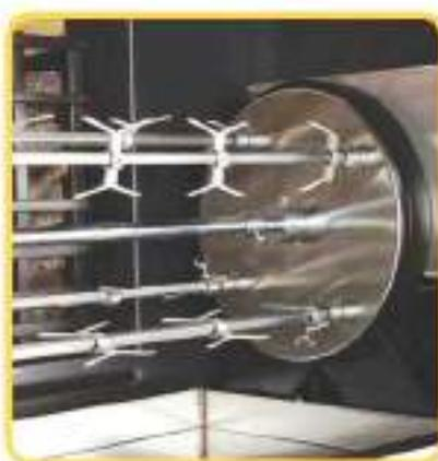
► Sistema planetario costruito in Acciaio inox AISI 304
